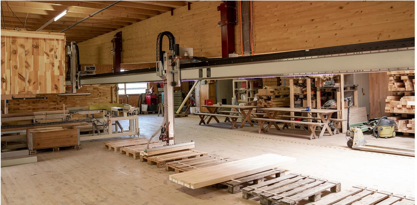
Hand der Zuschnittmaschine entnehmen, inspizieren und anschliessend auf die korrekte Palette laden müssen. Dies ist eine sehr körperliche und repetitive Arbeit.
