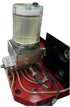
**1** FlexxPump mittels Schrauben an Winkel montieren (Zugänglichkeit zur Aktionsfläche des Pumpentyps 40IB und Display LCD beachten)
