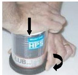
8. Appuyer le capot vers le bas et tourner la bague noire dans le sens des aiguilles d'une montre.
