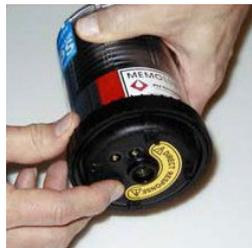
9. Simuler manuellement un test de fonctionnement. Appuyer l'embout du capteur sur le dessous du boîtier pendant env. 5 sec.
