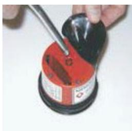
Remarque : Si nécessaire, préparer le MEMOLUB® HPS avec une pompe de graissage manuelle (*uniquement pour les cartouches à graisse*).
