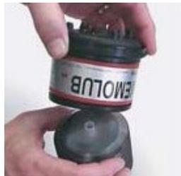
4. Den Verschluss der Kartusche sorgfältig entfernen. Das Gehäuse kopfüber auf die Kartusche setzen.
