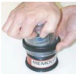
6. Die Haube über das zusammengebaute Gehäuse und die Kartusche s tülpen.
