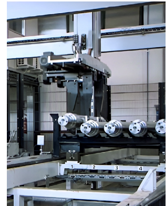
Güdel Portal legt eine fertige Achse in Transportpalette ab
