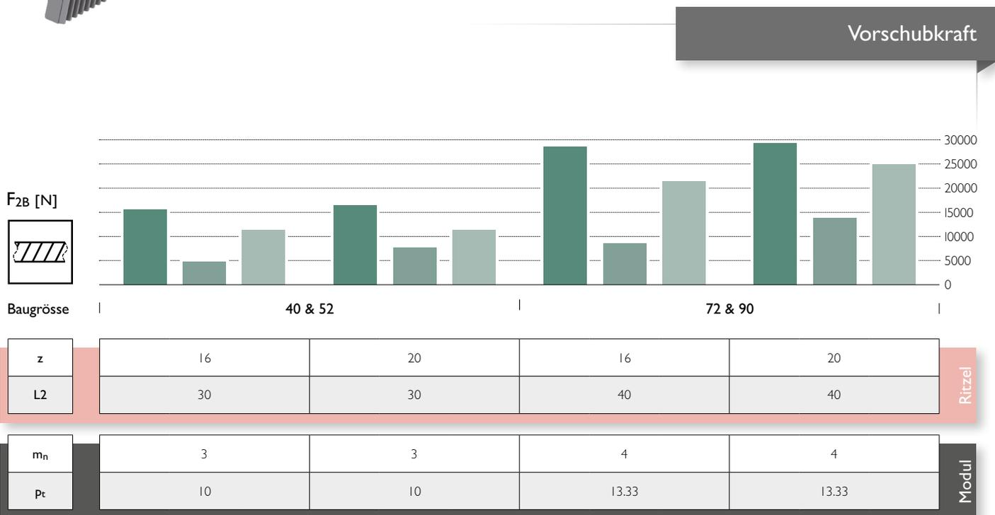
z: Zähnezahl, L<sub>2</sub>: Zahnbreite [mm], m<sub>n</sub>: Normalmodul, p<sub>t</sub>: Stirnteilung [mm]
