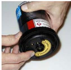
9. Funktionstest per Hand simulieren. Den Sensorstift an der Unterseite des Gehäuses ca. 5 Sec. drücken.
