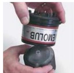
5. Den Verschluss der Kartusche sorgfältig entfernen. Das rote Gehäuse kopfüber auf die Kartusche setzen.
