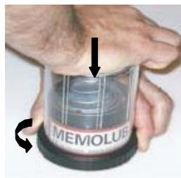
2. Zum Öffnen, den Schmierstoffgeber auf eine flache Unterlage stellen. Die Haube nach unten drücken und im Gegenuhrzeigersinn am schwarzen Ring drehen.
