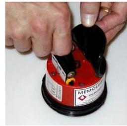
3. Kartusche und Batterien entfernen und Umweltgerecht entsorgen. Neues Batterieset einlegen, gemäss der Anleitung auf dem roten Gehäuse.
