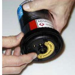
9. 手动模拟功能测试。按压外壳底部的感应针约5秒。
