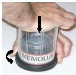
2. 为打开，将注油器放在平整的垫子上。将盖子向下压，并逆时针转动黑色环。
