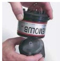
5. 小心地取下储油包的封口。把红色外壳倒转放到储油包上。
