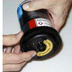
9. Simulare manualmente un test di funzionamento. Premere il perno del sensore sulla parte inferiore del corpo per ca. 5 sec.
