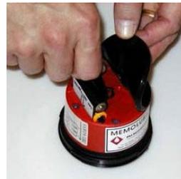
3. Rimuovere la cartuccia e le batterie e smaltirle nel rispetto dell'ambiente. Inserire un nuovo set di batterie, come da istruzioni sul corpo rosso.
